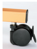
ロック解除時 ロックをすると支柱が降りて、車輪部が深くことでキャスターの動きを止めるリフトロックキャスターを採用。
